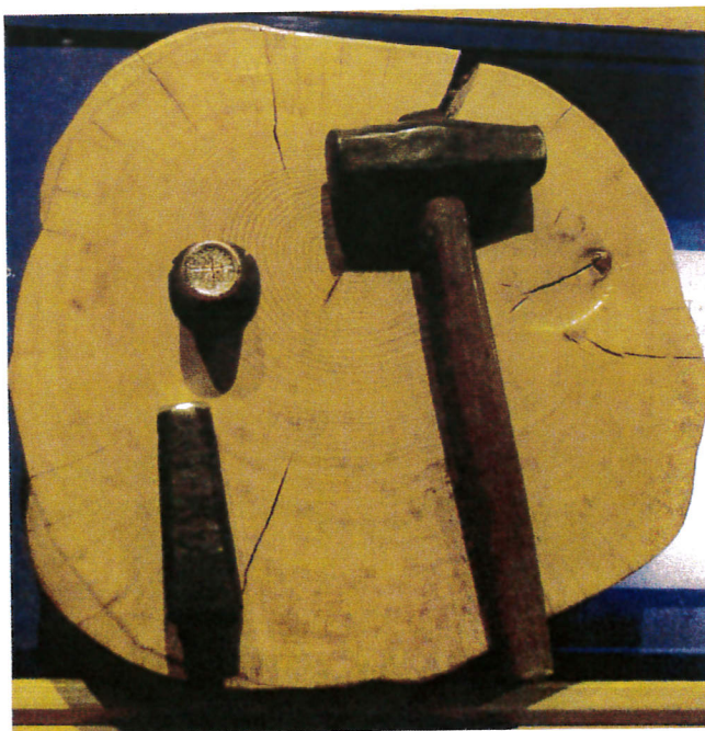
Il conio della moneta a martello, con matrice e punzone (London, Tower of London)
